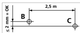
Sie, ob die waagerechte Linie von Punkt C  $\pm 2$  mm auf der gleichen Höhe mit dem Punkt B liegt. Vorgang durch Schwenken nach links wiederholen.
