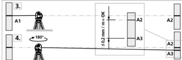
! Wanneer het verschil tussen punt A2 en A3 groter is dan de aangegeven tolerantie, nl. 0,2 mm / m, is een kalibratie nodig. Neem hiervoor contact op met uw vakhandelaar of met de serviceafdeling van UMAREX-LASERLINER.
