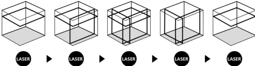
**!** Til horisontal og vertikal nivellering skal transportsikringen være løsnet. Så snart apparatet er uden for det automatiske nivelleringsområde på  $3,5^\circ$ , blinker laserlinjerne. Apparatet skal positioneres således, at det er inden for nivelleringsområdet. Laserlinjerne lyser konstant op igen.
