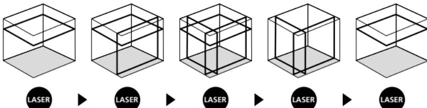
! Per il livellamento orizzontale e verticale si deve allentare la sicura di trasporto. Non appena l'apparecchio si venisse a trovare al di fuori del campo di livellamento automatico di 3,5°, le linee laser iniziano a lampeggiare. Posizionare l'apparecchio in modo che si trovi all'interno del campo di livellamento. Le linee laser si riaccendono costantemente.
