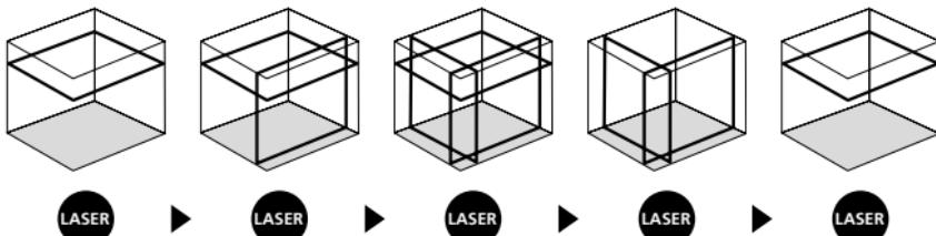
! Zum horizontalen und vertikalen Nivellieren muss die Transportsicherung gelöst sein. Sobald sich das Gerät außerhalb des automatischen Nivellierbereichs von  $3,5^\circ$  befindet, blinken die Laserlinien. Positionieren Sie das Gerät so, das es sich innerhalb des Nivellierbereichs befindet. Die Laserlinien leuchten wieder konstant.
