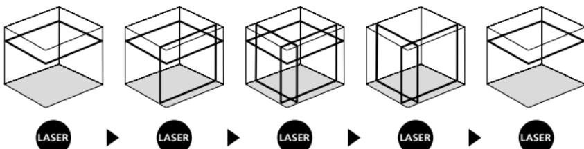
! Para poder efectuar la nivelación horizontal y vertical tiene que estar suelto el seguro de transporte. Cuando el aparato se encuentra fuera del rango automático de nivelación de 3,5° las líneas láser parpadean. Coloque el aparato en una posición dentro del rango de nivelación. Las líneas láser vuelven a iluminarse constantemente.
